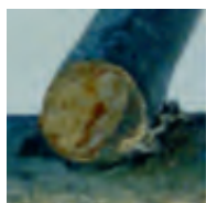
Rouille rouge superficielle sur la coupe
